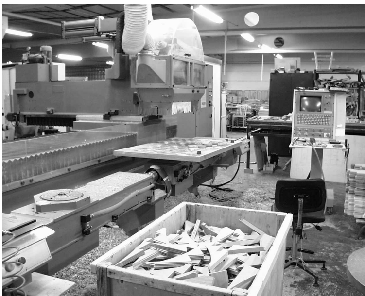
Figur 2: Numeriskt styrd överfräs. Notera restprodukterna i lådan framför maskinen.
