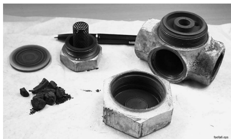
Figur 11.45: Demonterad termodynamisk kondensatavledare, typ Spirax Sarco TD 50S. Foto: Stig-Inge Gustafsson.
