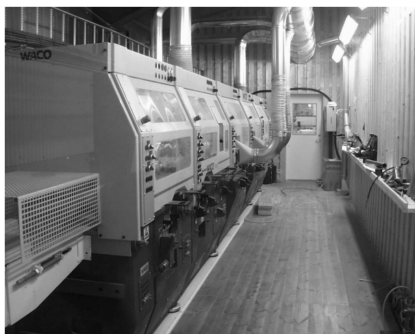
Figur 4.15: Sektionsuppbyggd hyvel av fabrikatet Waco vid sågverket Boo Hjortkvärv AB. Foto: Stig-Inge Gustafsson.
