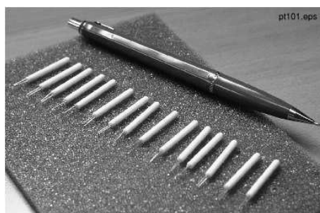
Figur 11.40: Temperaturgivare för datoriserade mätsystem. Foto: Stig-Inge Gustafsson.
