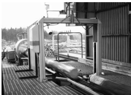
Figur 5.4: Mätram av typen Remalog, Wilhelmsson Trävaru AB, Lingham. Foto: Stig-Inge Gustafsson
