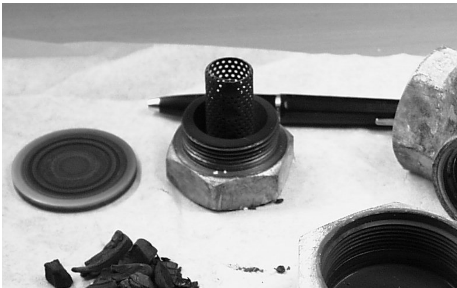
Figur 148. Demonterad termodynamisk kondensatavledare, typ Spirax Sarco TD 50S.
